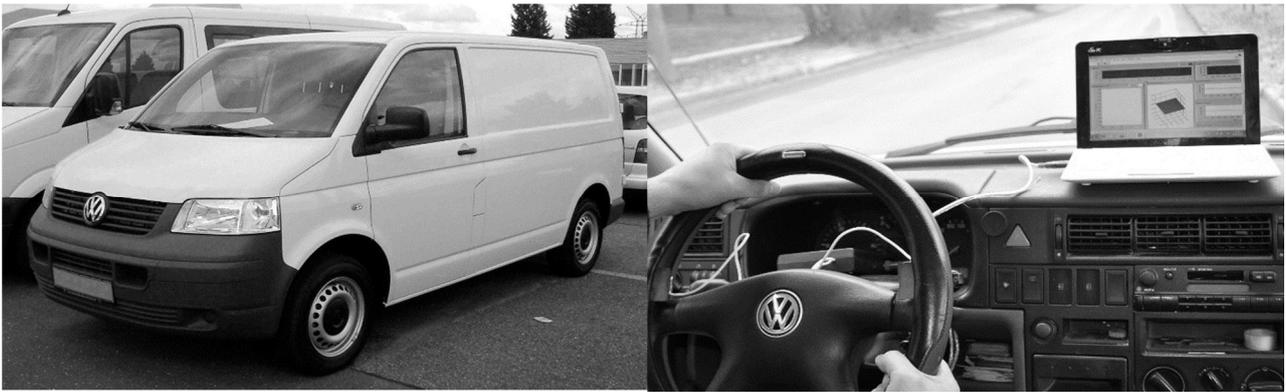
Рисунок 5 – Устройство оценки изменения состояния водителя, установленное на автомобиль
