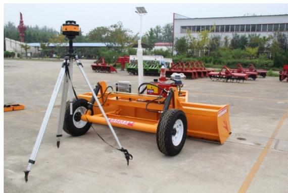
*Рис. 3. Лазерный рубанок и его устройства*
