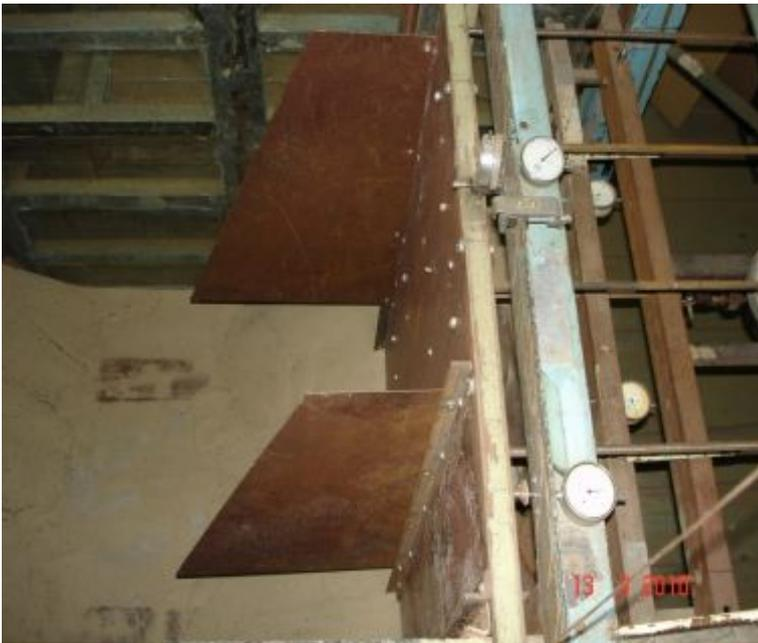
*Рис. 4. Общий вид модели подпорной стенки*
