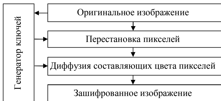
Рис. 1. Структурная схема алгоритма шифрования
