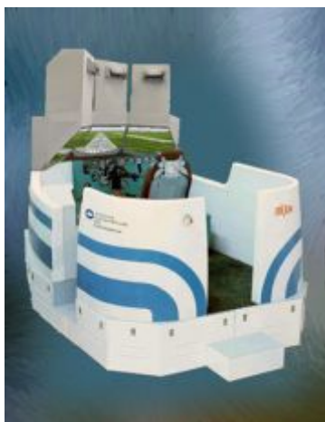
Рис.3 – Пример трёхканального ИВО, разработанного в ПКБМ, с тремя УИ на базе коллиматора с «узким зрачком»
