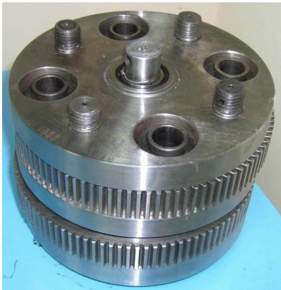
Рис. 11 - Блок сателлитов планетарной передачи, выполненной по схеме рис. 10 ( $m = 1,5$ ;  $z_g = 100$ ;  $\Delta z = 2$ )
