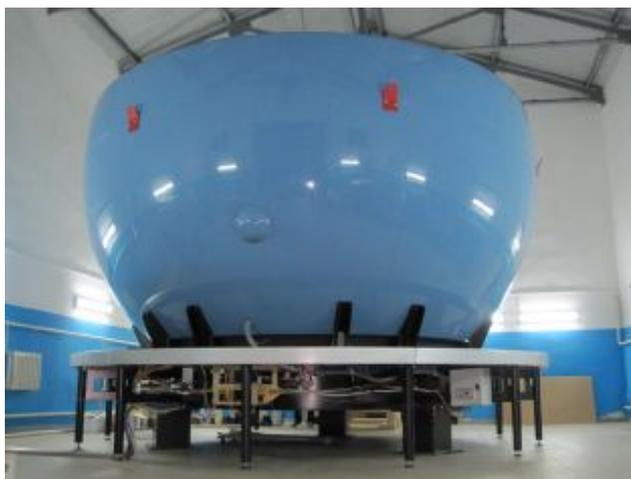
Рис.4 – Пример кабины тренажёра АТ с ИВО с УИ на базе коллиматора с «широким зрачком» (2)
